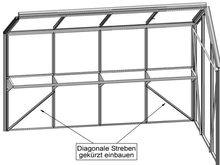
3. An sturmgefährdeten Standorten kürzen Sie die ausgebauten Diagonalen und montieren Sie wie in der nebenstehenden Abbildung gezeigt, unterhalb des Regals.
